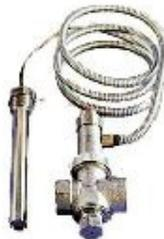
Die thermische Ablaufsicherung ist ein Schutz gegen überhitzen des Holzvergaser. Bei Temperaturen über 95°C wird kaltes Wasser durch den eingebauten Kupfersicherheitswärmetauscher gespült um den Holzvergaser abzukühlen.
