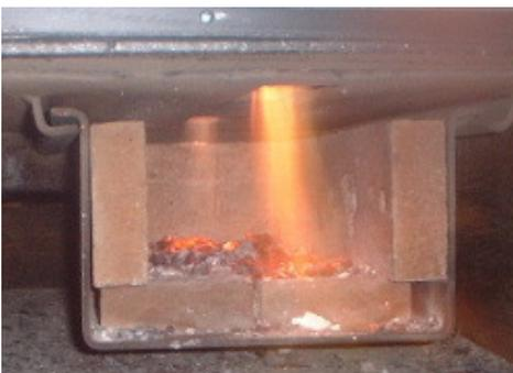
Der Vigas Kessel arbeitet nach dem Sturzbrandprinzip. Durch die große rechteckige Fülltür werden die Scheite eingelegt. Nach dem Zünden wird das Holzgas durch eine hitzebeständige keramische Brennerdüse in den Verbrennungsraum geleitet. Ein Druckgebläse sorgt dort für eine ausreichende Menge an Luft. Das Gas-Luftgemisch erreicht in der Brennkammer eine Verbrennungstemperatur von bis zu 1200 Grad. Diese hohen Temperaturen sorgen dafür, dass eine maximale Energieausbeute
